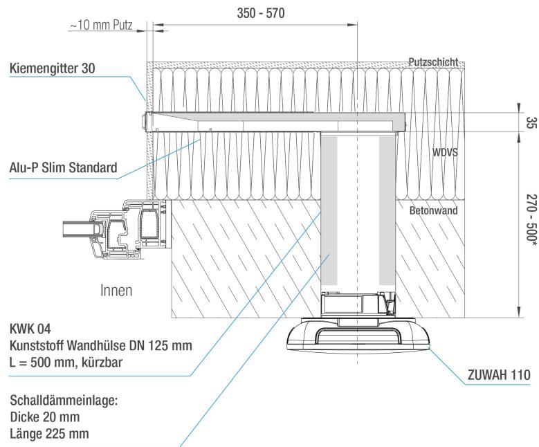
\* Schallprüfung bei 320 mm Wandhüsenlänge durchgeführt. Zur Bewertung kürzerer Rohrlängen TI-P-22 beachten.
