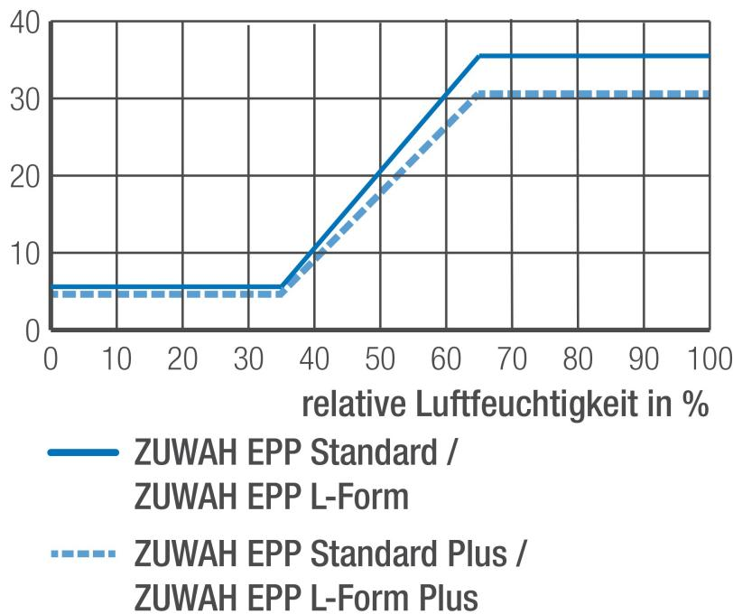
Nach DIN 1946-6 wird als qv, ALD der max. hygrometrische Volumenstrom für die Berechnung angesetzt. Die Werte bei 10 und 20 Pa haben lediglich Orientierungscharakter. Differenzdrücke zur Auslegung der ALD nach DIN 1946-6:2019-12: Freie Lüftung nach Formel 24 oder Tabelle 13 / Ventilatorgestützte Lüftung nach Tabelle 19 dieser Norm.
