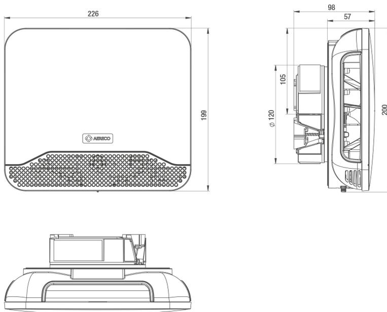
KWK 04 (Ohne Putzschutzabdeckung und Schalldämmeinlagen dargestellt)
